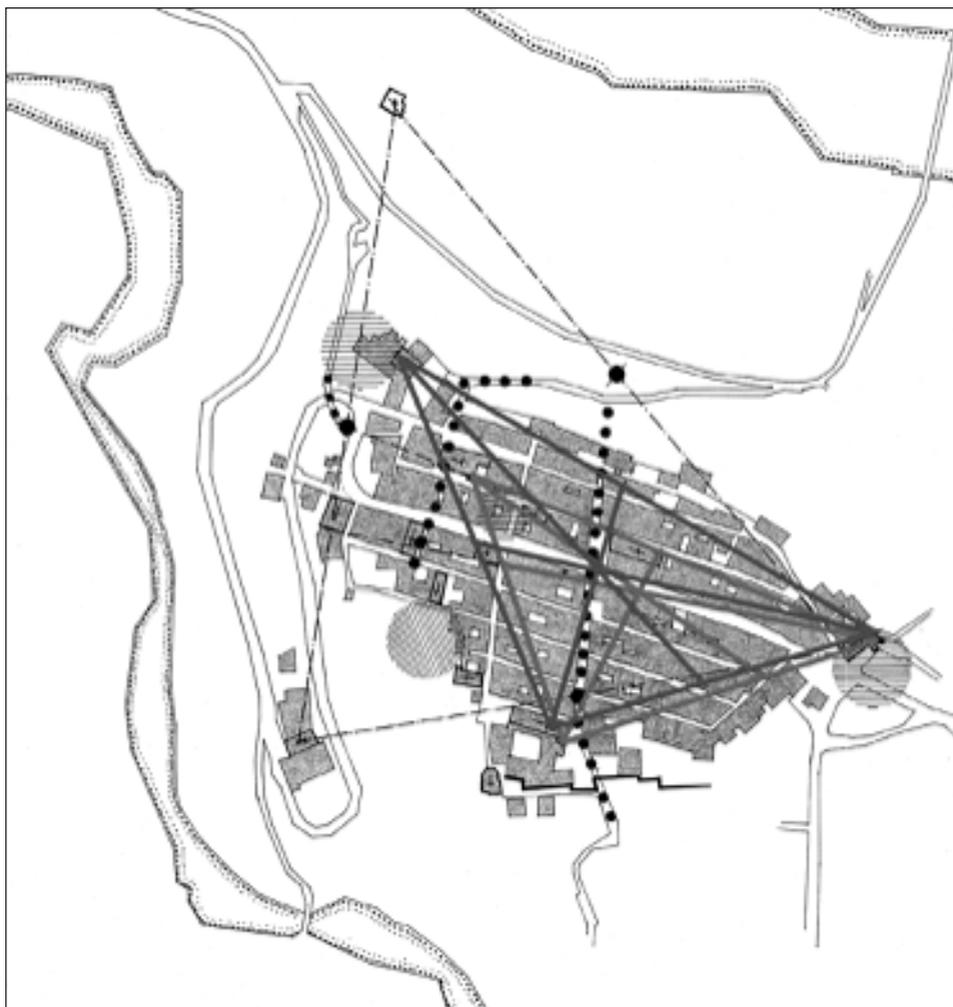
Fig. 10. Confronto tra la triangolazione che si ottiene unendo i campanili delle tre chiese utilizzate da Guidoni che individua un punto poco definito della città con la triangolazione ottenuta unendo i campanili delle tre chiese conventuali, questa triangolazione individua con una precisione singolare l'attuale torre civica.
