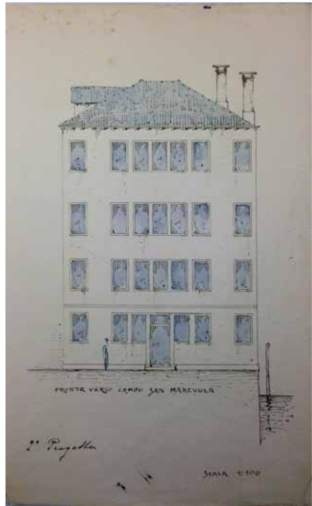
Fig. 109. Arch. Ambrogio Narduzzi, Secondo progetto per nuovo edificio a San Marcuola, 2 ottobre 1923 (AMV, 1936-40, X/7/11, prot. 19018). Il progetto è definito dallo stesso Narduzzi «la fabbrica caserma» per la semplicità nell'organizzazione delle aperture e dalla decorazione completamente assente.
