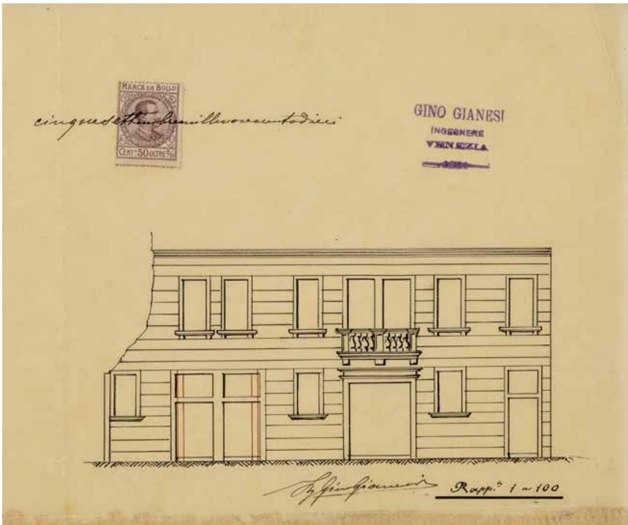
Fig. 113. Ing. Gino Gianesi, Edificio da sopraelevare in calle Priuli a Cannaregio, 9 settembre 1909 (AMV, 1921-25, IX/1/11, prot. 30754). Il disegno mostra alcune modifiche proposte per l'attacco a terra della casa in linea da sopraelevare di proprietà di Margherita Sarfatti.
