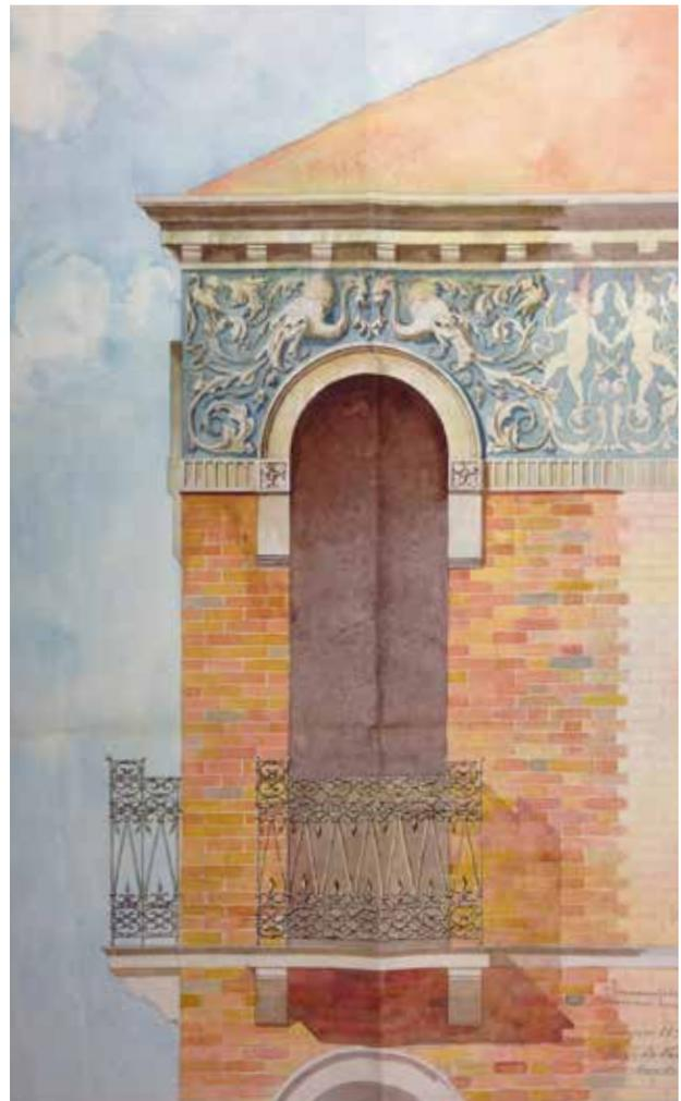
Fig. 111. Arch. Ambrogio Narduzzi, Dettaglio del terzo progetto per nuovo edificio a San Marcuola, 11 febbraio 1924 (AMV, 1936-40, X/7/11, prot. 19018). La Commissione chiede per questo progetto che tutte le decorazioni siano in laterizio, limitando l'uso della pietra artificiale alla sola cornice di gronda.
