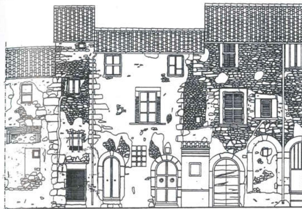
Fig. 6/ Casa-torre di vicolo del Corallo. Prospetto su via Piè di Palazzo (da originale in scala 1:50).
