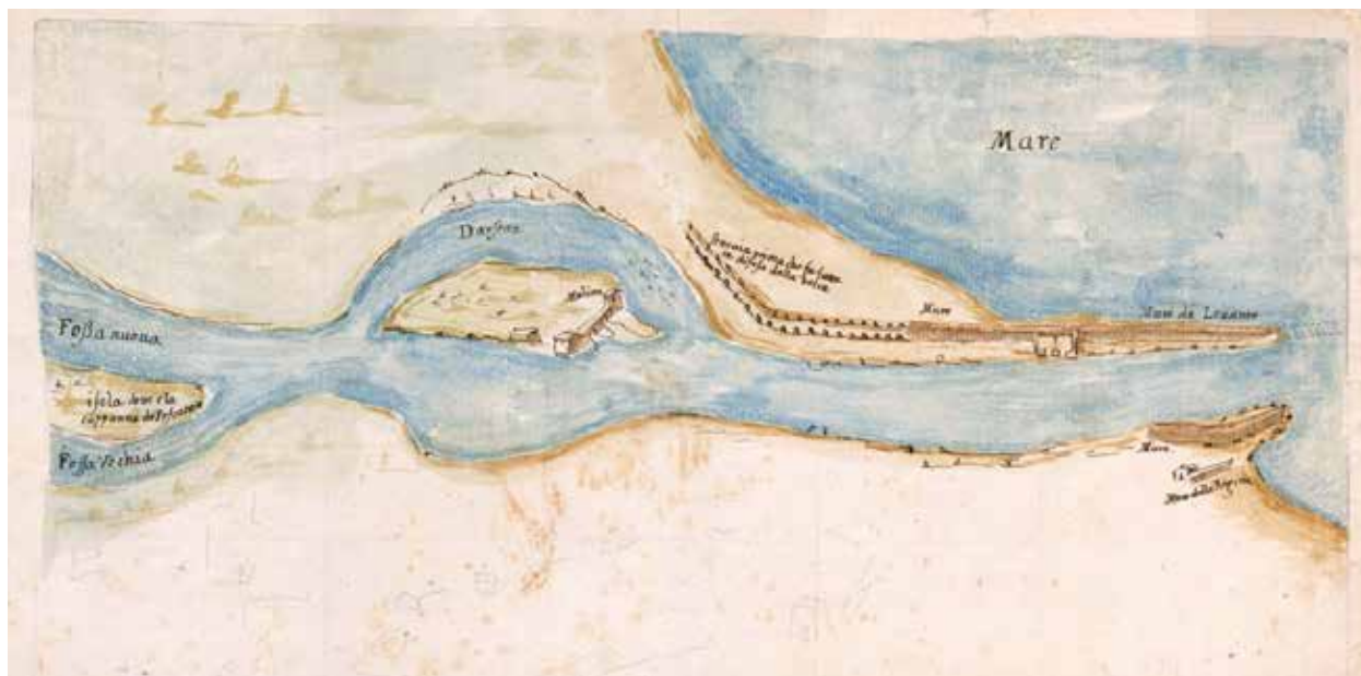
7. Castiglione della Pescaia. Nel disegno sono evidenziate la Fossa Nuova e la Fossa Vecchia di comunicazione con le aree palustri interne che offrivano il riparo nella più interna Darsena, con una serie di opere palizzate litoranee e a mare, nominate già alla fine del Duecento: sono indicate una Stecaia prima, il Muro di Levante, e a nord il Muro e il Muro della Regina). Mappa non datata e assegnata al periodo 1550-1600 nella scheda redatta da Anna Guarducci (Pianta prospettica del porto canale di Castiglione della Pescaia, Archivio di Stato di Firenze, Miscellanea Medicea, Mappe e disegni, 93/IV - Progetto CASTORE - CARTografie STOriche REgionali).
