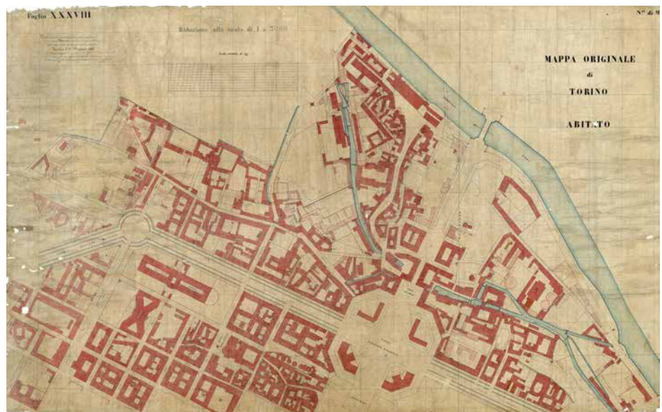
5. L'andamento della Dora e dei canali derivati nelle aree del cimitero e del Borgo Dora. Si apprezza il primo, consistente, ampliamento del cimitero, così come in parte riportato nella tavola di progetto di Magistrini, che impone una limitata rettificazione del corso della Dora, ancora caratterizzato da ampie anse, 1866. Antonio RABBINI, Mappa originale del Comune di Torino, cosiddetto "Catasto Rabbini", 1866. ASTO, Riunite, Finanze, Catasti, Catasto Rabbini, fogli XVIII (scala 1:6000) e XXXVIII (scala 1:3000) (gratuitamente concessa).
