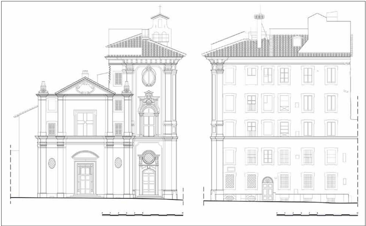
*7. Prospetti della chiesa e del convento di Santa Maria in Monterone. Le due tipologie di apertura a bocca di lupo, evidenziano due differenti fasi costruttive. Le prime due di forma ellittica, furono verosimilmente realizzate contestualmente al prospetto principale del convento, mentre le ultime tre di forma rettangolare potrebbero appartenere alla fase di ampliamento e unificazione del prospetto su via dei Redentoristi. (elaborazione dell'autrice).*
